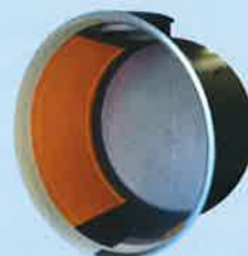
4. 特殊アルミシートの上から、エポキシ樹脂FRPライニングを施工しSST3ダブルウォールを完成させる。
